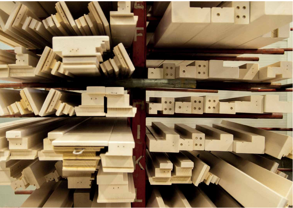
Alle Bestandteile des Fensterrahmens werden im Ganzen vor dem Kleben lackiert.
